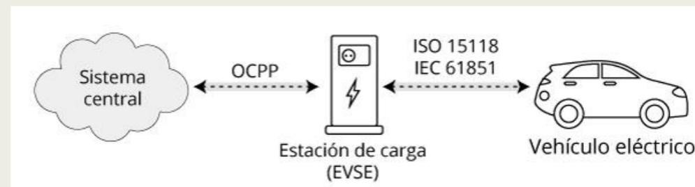
Entre vehículo y estación de carga (conexión eléctrica). Entre estación de carga y sistema central (conexión de comunicaciones de red) → OCPP
